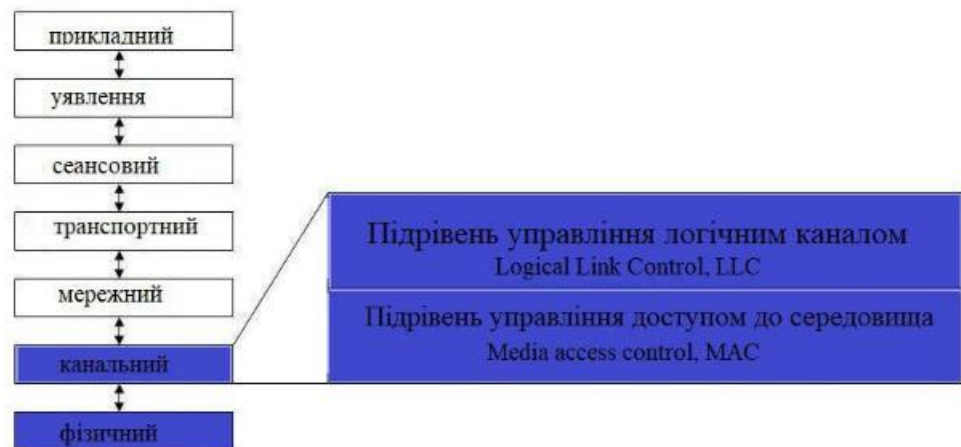
Рисунок 1.6 – Місце Ethernet у моделі OSI
