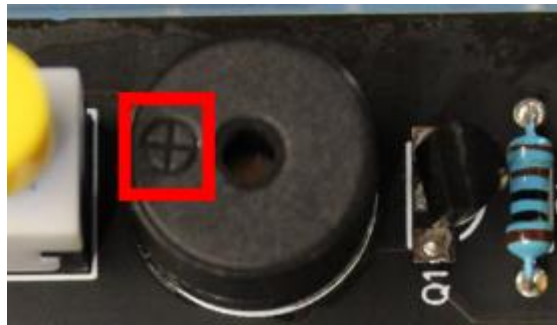
Рисунок 2.8 Зумер (Звуковий модуль: для відтворення звуків гри.)
