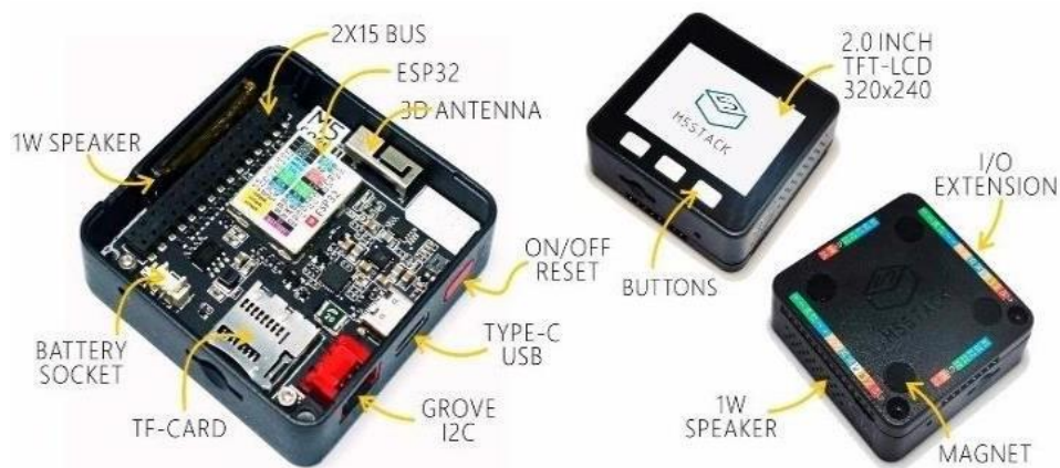
Рис. 1.2. Структура платформи M5Stack
